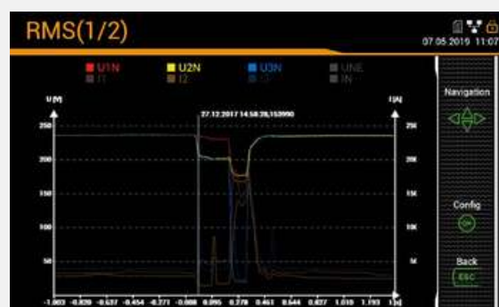
Caída de voltaje mostrada en la pantalla local
